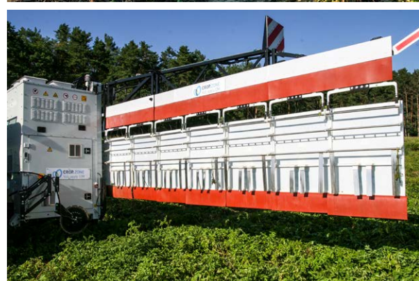
Wie Flügel sehen die Applikatoren im hochgefahrenen Zustand aus, über deren Metallgestänge der Strom in die Pflanzen geleitet wird.
